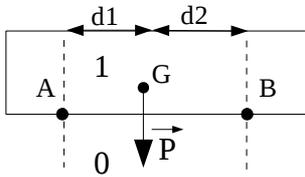
On sait donc qu'il est soumis à la force  $\vec{A}$  au point A, la force  $\vec{B}$  au point B et le poids  $\vec{P}$  au centre de gravité G.
